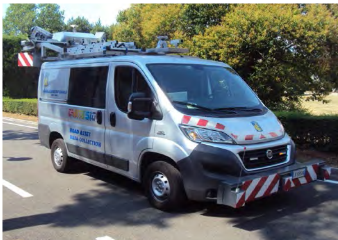
Figura 4 - Mezzo ad AR CARTESIO con sistema Laser Scanner per l'aggiornamento del Catasto Strade e con sistema LCMS per il rilievo dei difetti delle pavimentazioni.
