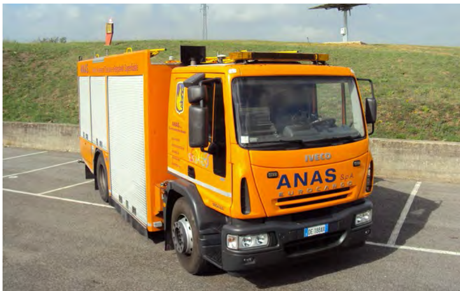
Figura 3 - Mezzo ad AR ERMES per la misura dell'aderenza stradale (CAT), la tessitura (MPD) e la regolarità superficiale delle pavimentazioni (IRI).
