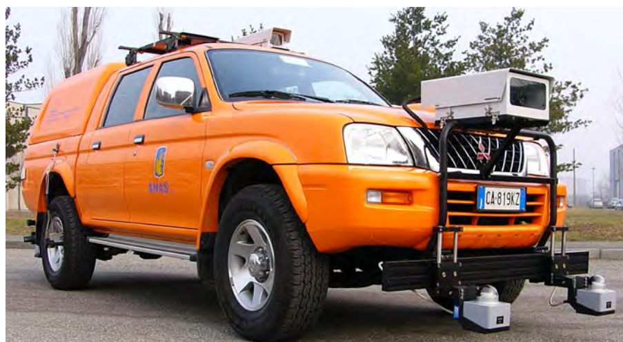
Figura 5 - Mezzo ad AR TIRESIA per la misura dell'illuminamento e della luminanza degli impianti di illuminazione in galleria e su strada.
