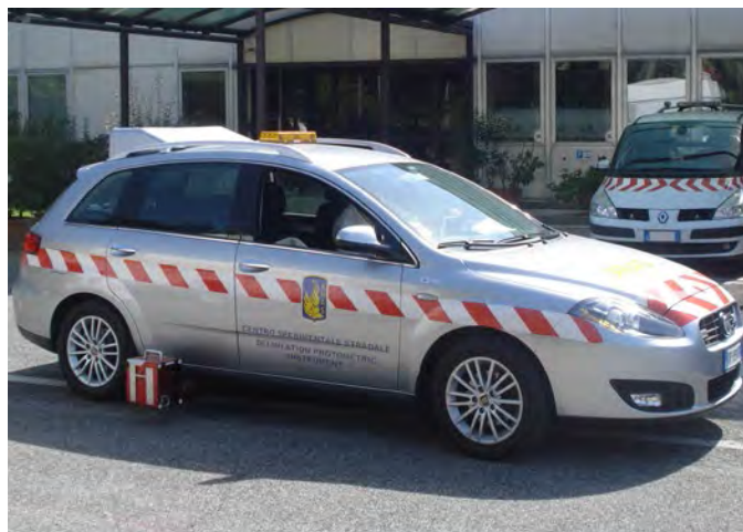
Figura 6 - Mezzo ad AR DELPHI per la misura del "coefficiente di luminanza retroriflessa" (RL) sulla segnaletica orizzontale.
